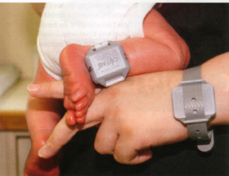
Transponderpaar bei Mutter und Kind schließen Verwechslungen aus.
